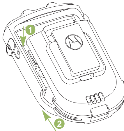
Figura 2.2: Colocación de la batería en el WRSM
