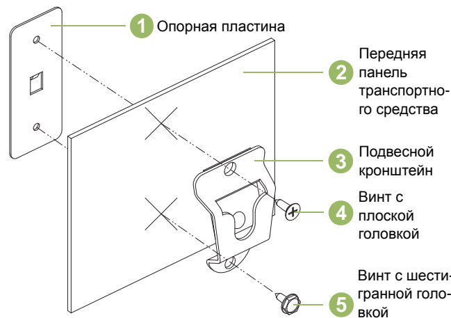
Рис. 3.1. Установка монтажного кронштейна
