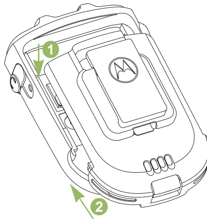
Figura 2.2: Colocación de la batería en el WRSM
